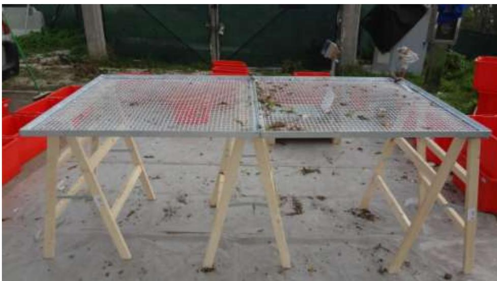
Fig. 55 rete metallica utilizzata come vaglio per le analisi merceologiche.
