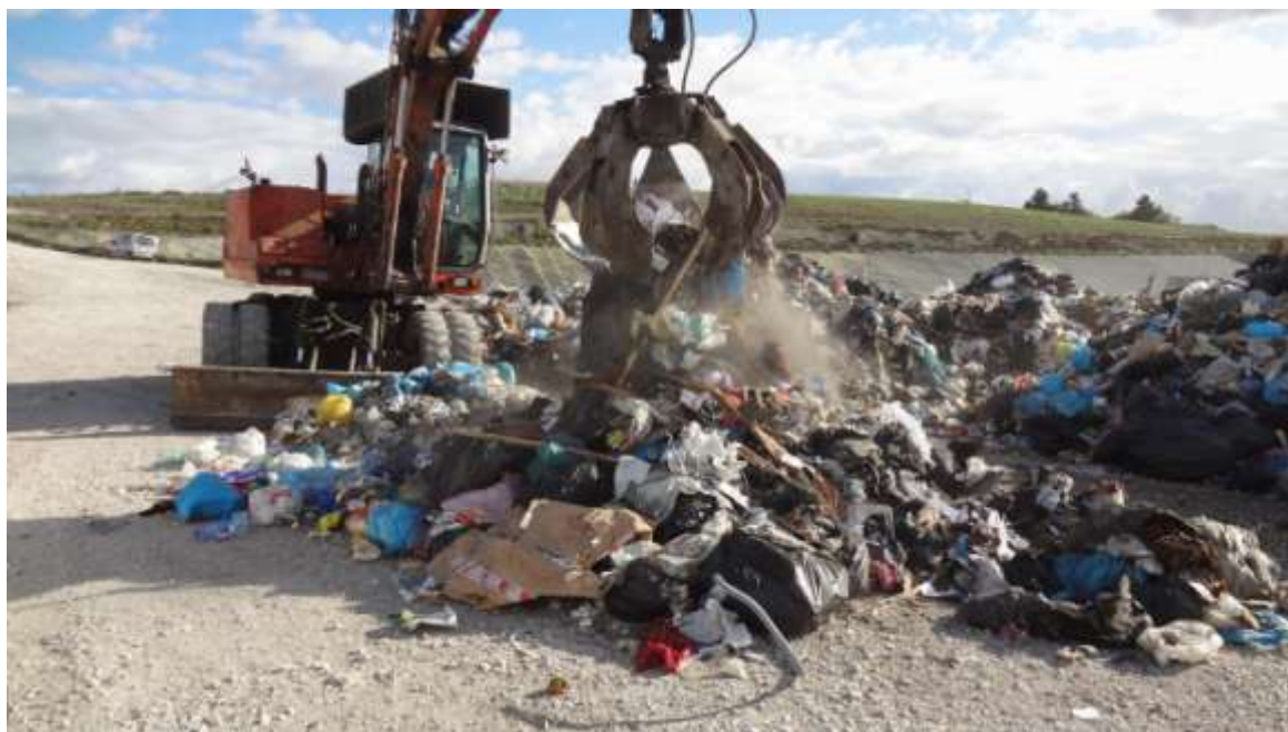
Quartatura svolta tramite benna a ragno
