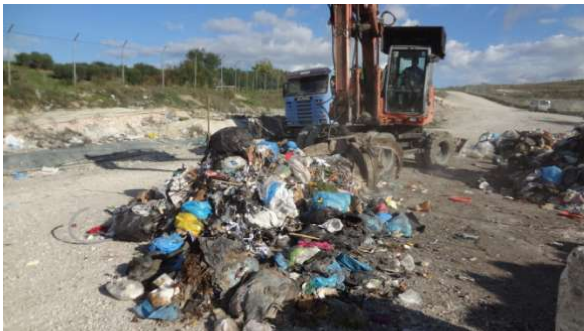
Quartatura svolta tramite benna a ragno
