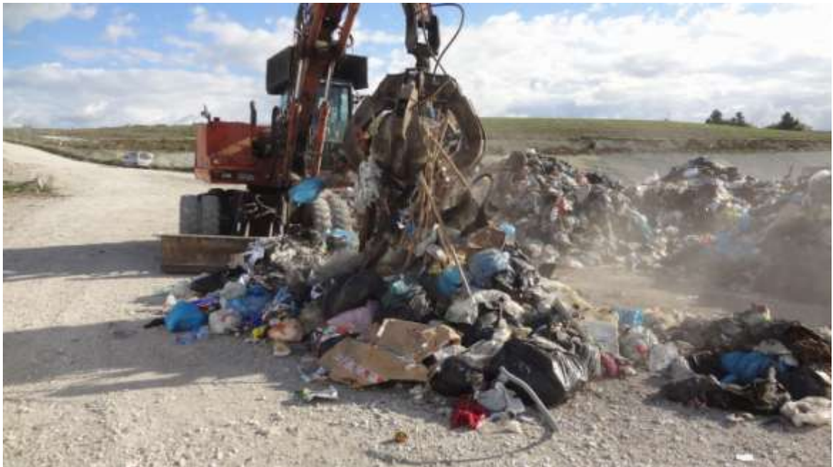
Quartatura svolta tramite benna a ragno
