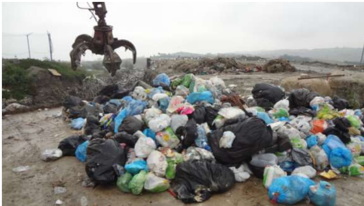
Operazioni di quartatura tramite benna a ragno
