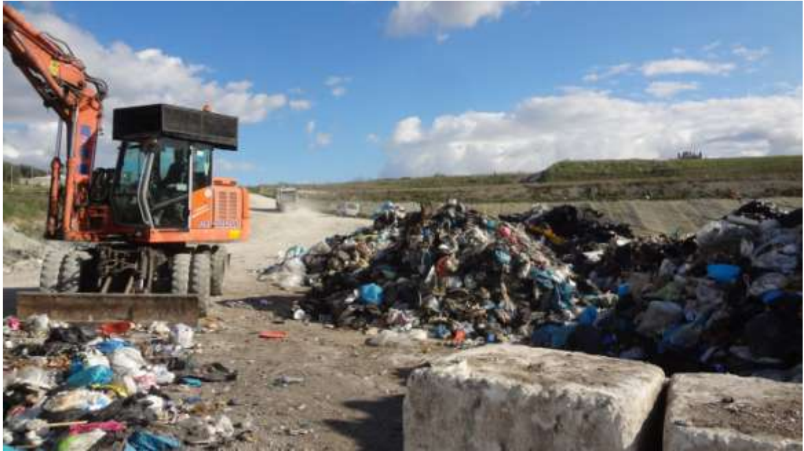
Quartatura svolta tramite benna a ragno
