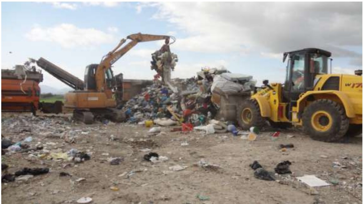
Operazioni di quartatura svolte con benna a ragno e pala gommata
