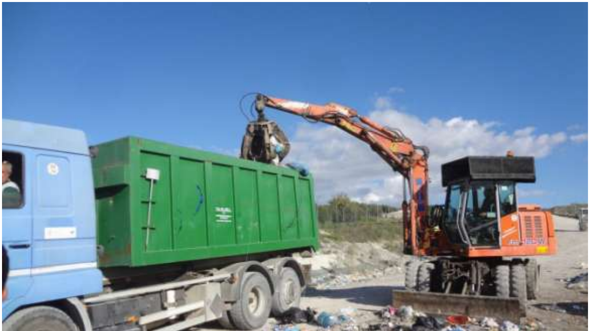
Quartatura svolta tramite benna a ragno Quartatura svolta tramite benna a ragno
