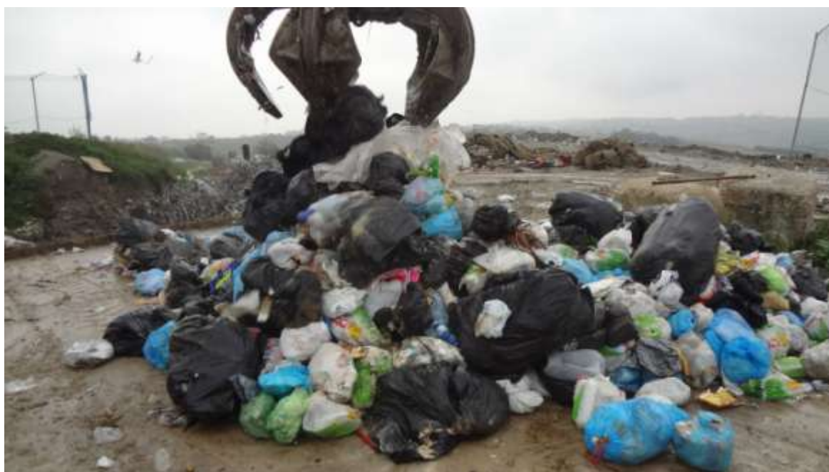
Operazioni di quartatura tramite benna a ragno
