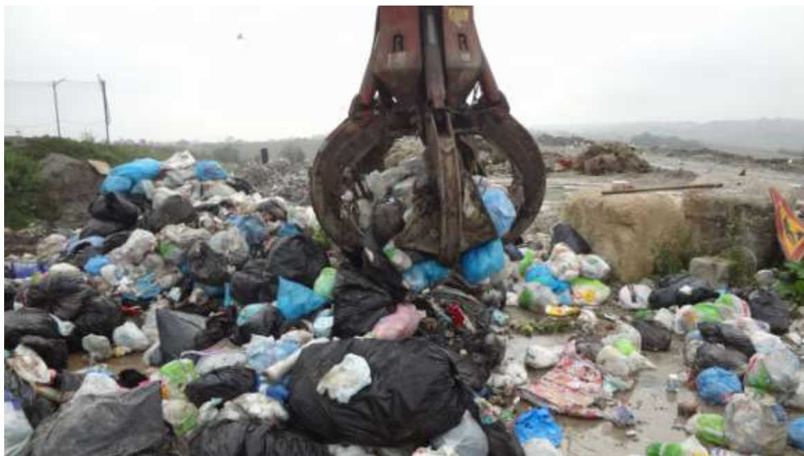
Operazioni di quartatura tramite benna a ragno
