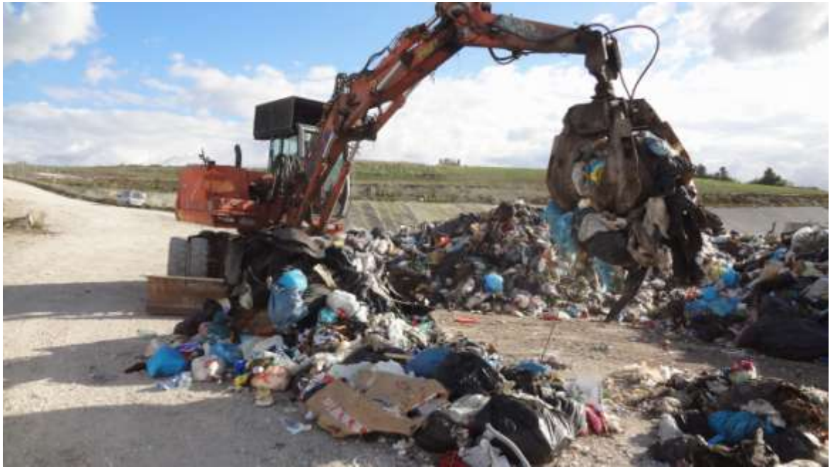
Quartatura svolta tramite benna a ragno
