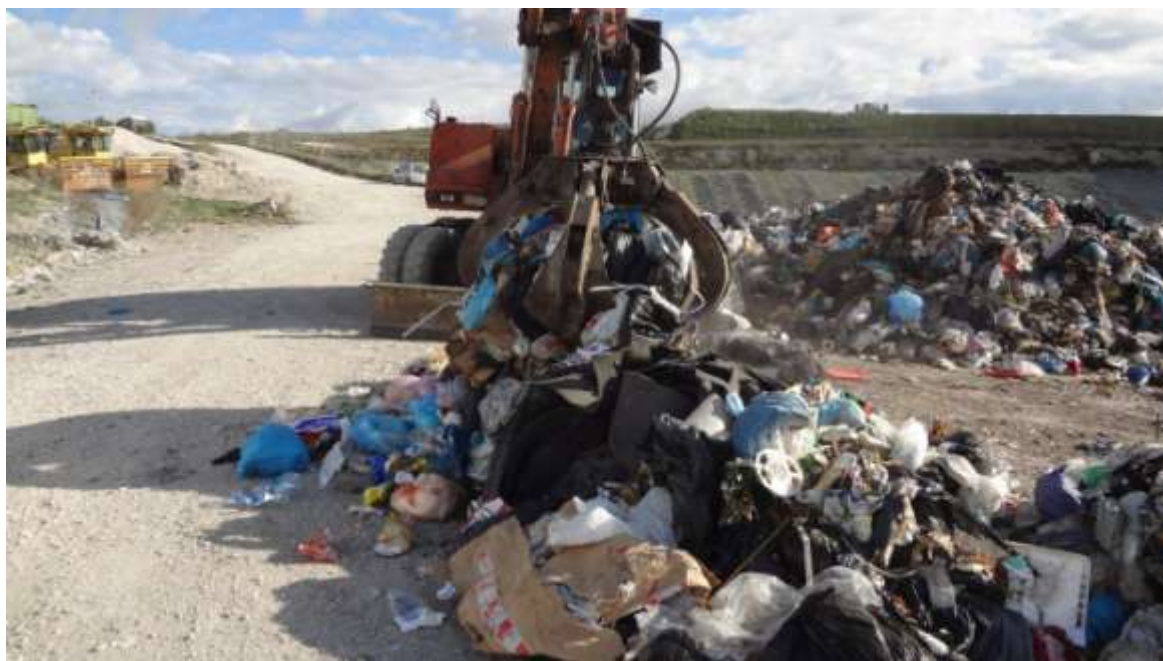
Quartatura svolta tramite benna a ragno
