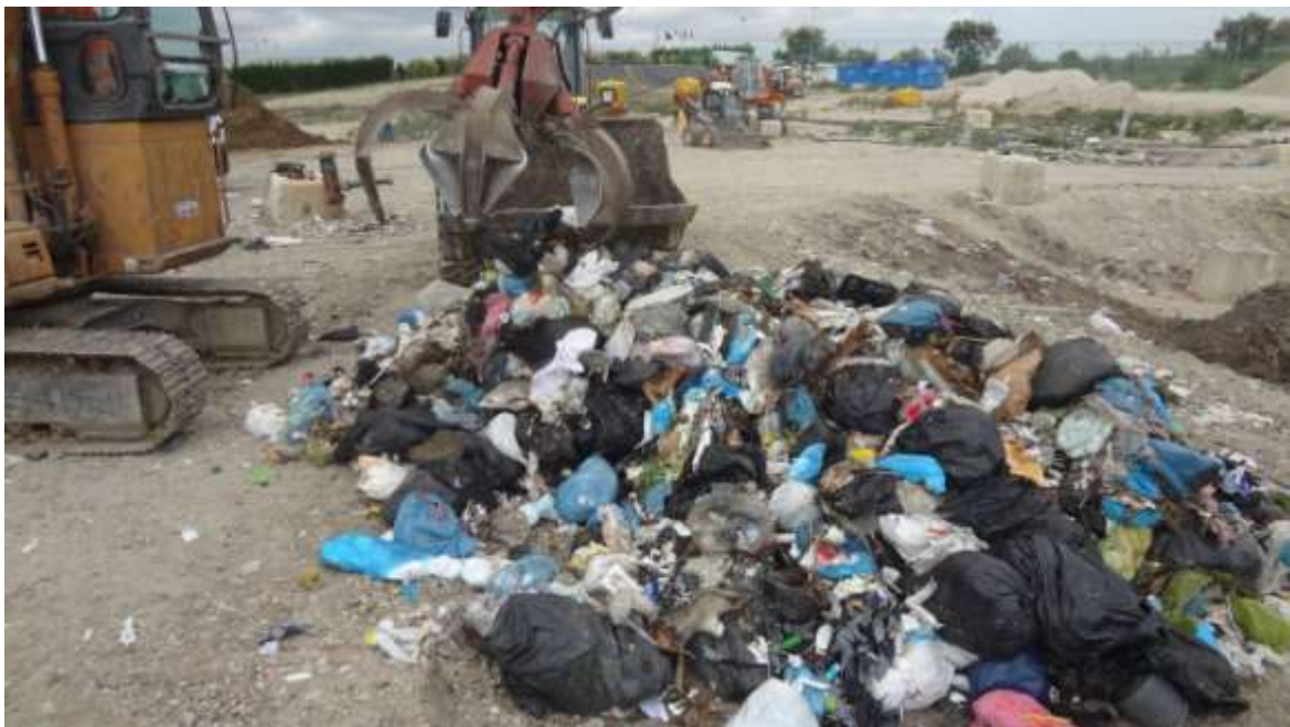
Operazioni di quartatura svolte con benna a ragno e pala gommata
