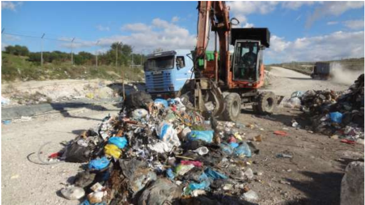
Quartatura svolta tramite benna a ragno
