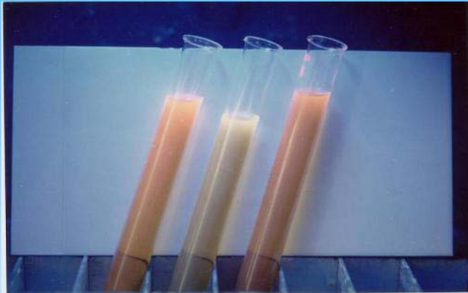
Fig. 2: tre campioni di olio di oliva alla luce di Wood; quello centrale è contaminato da IPA
